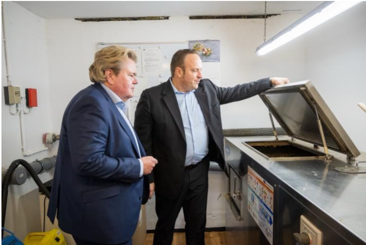
Der Bio-Konverter wandelt das Einmalgeschirr in Fasern für die Pappenindustrie um. Foto: Dreimüller
